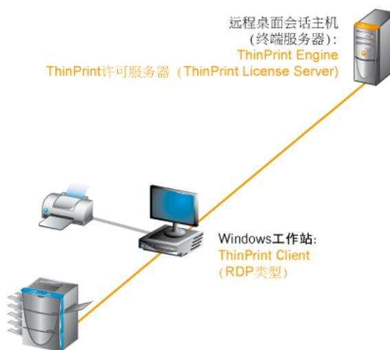
图 1 许可服务器 (License Server), ThinPrint Engine 和 ThinPrint Client 实例图解
